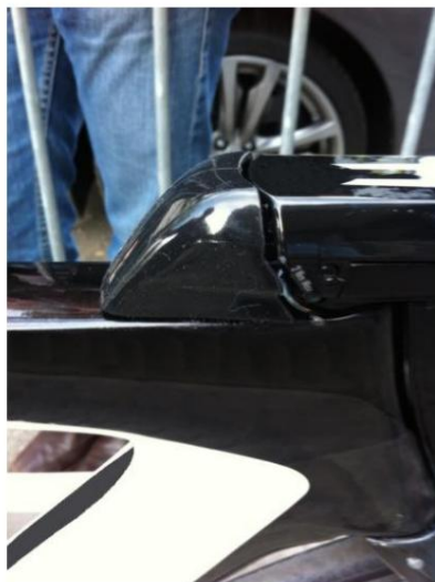
Figura 54: Cobertura adicionada ao quadro para ocultar os cabos do freio
