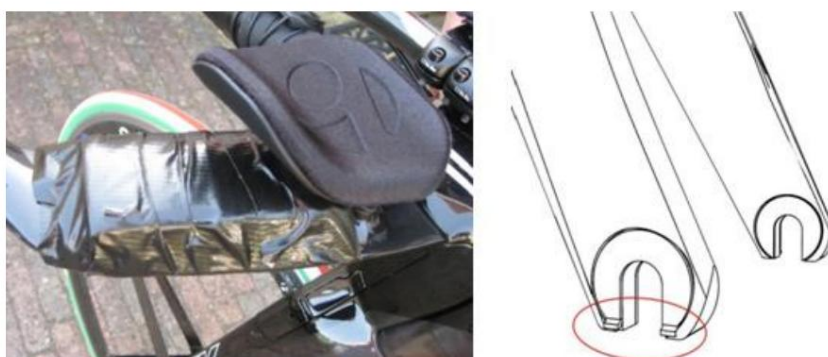
Figura 1: Exemplos de modificação proibida de equipamento (adição de fita, lixamento das alças de segurança do garfo)
