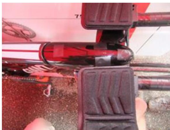
Figura 4: Ilustração da adição da fita adesiva para tampar o acesso aos parafusos
