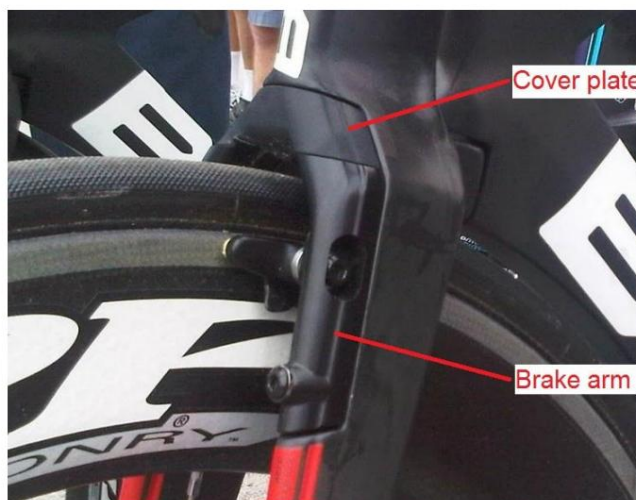
Figura 55: Freio integrado ao garfo e equipado com tampa
