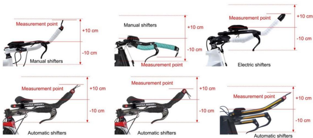
Figura 48: Pontos de medição dos limites verticais das extensões fixas adicionais de contra-relógio e eventuais acessórios
