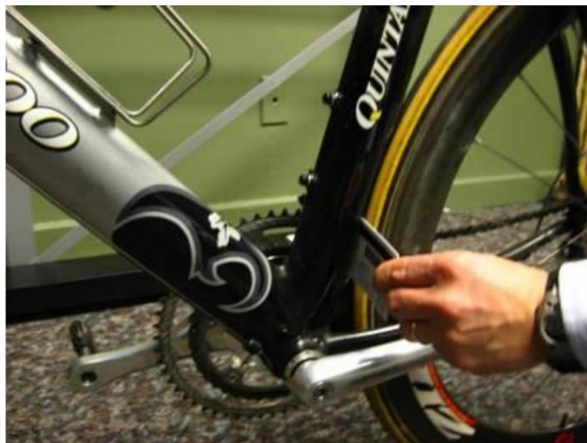
Figura 60: Inserção de cartão de crédito entre a roda e o quadro para verificar se não há carenagem
