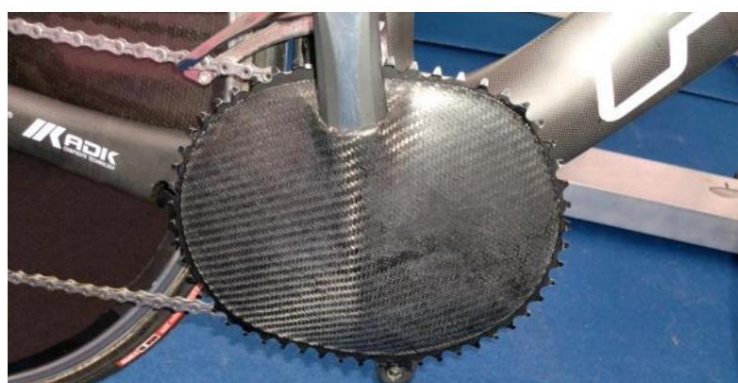
Figura 2: Exemplo de modificação proibida de equipamento (a cobertura de carbono adicionada ao a coroa)
