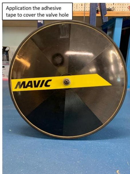
Figura 3: Exemplo de aplicação da fita adesiva na roda do disco Time Trial
